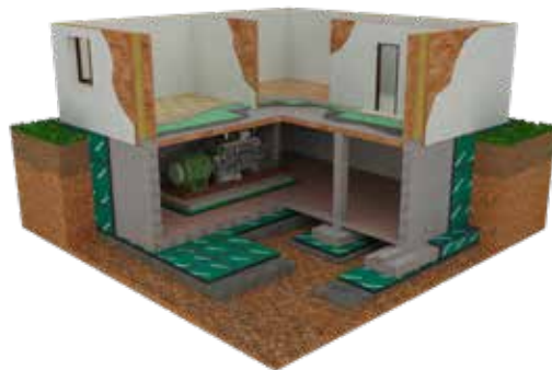
Exemplu de aplicare pe fundațiile clădirilor rezidențiale. Linia MEGAMAT
